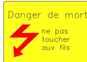
Plaque selon art. 16 OIEC en présence d'une caténaire. Ne doit pas être orienté directement dans le sens de marche.
