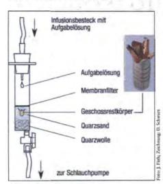
Abb. 1: Perkolationsanordnung und deformiertes Geschoss
