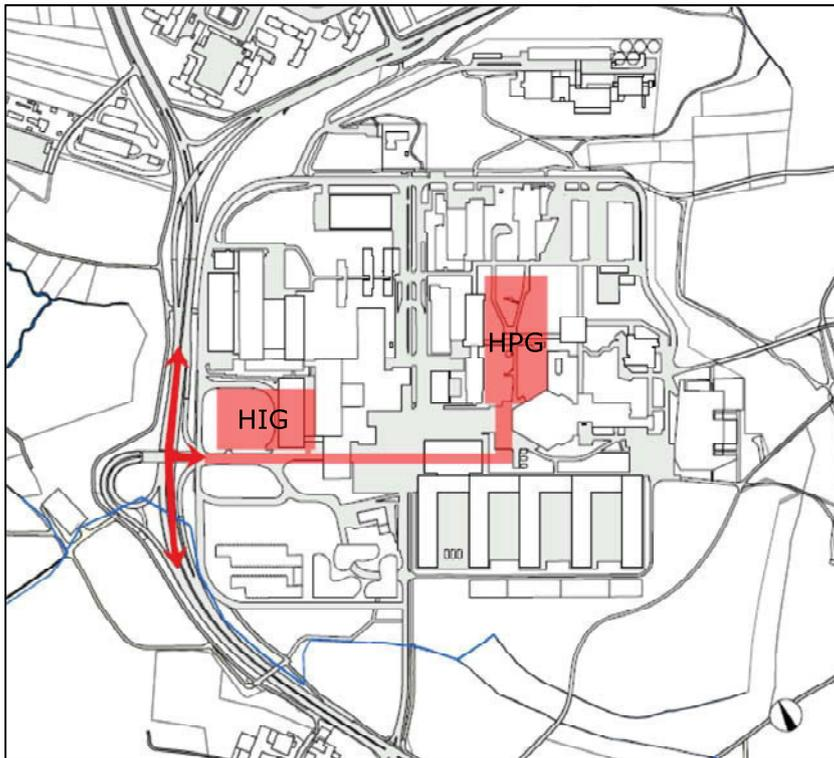
Abbildung 12: Schema der MIV-Erschliessung (rote Pfeile) und unterirdische Parkierungsanlagen (rote Flächen) ETH Höggerberg (Quelle: Schmid Landschaftsarchitekten GmbH)
