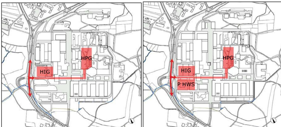
Abbildung 22: MIV-Erschliessung (rote Pfeile) und Parkierungsanlagen (rote Flächen) der ETH Höggerberg für die PH 2030 (links) und 2040 (rechts) (Quelle: Schmid Landschaftsarchitekten GmbH).
