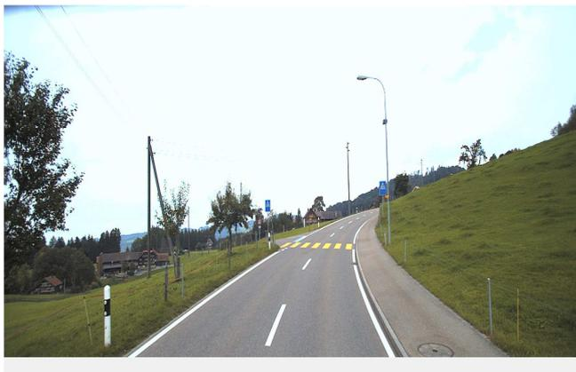
Bild 6; entfernter Fussgängerstreifen ausserorts in Abschnitt mit 80 km/h, fehlende Sichtweiten, geringe Verkehrszahlen, tiefe Fussgängerfrequenzen Kantonsstrasse Nr. 27, Teufen Battenhaus
