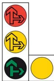
**J.02** Semaforo a tre colori con frecce e luce gialla lampeggiante (esempio)
