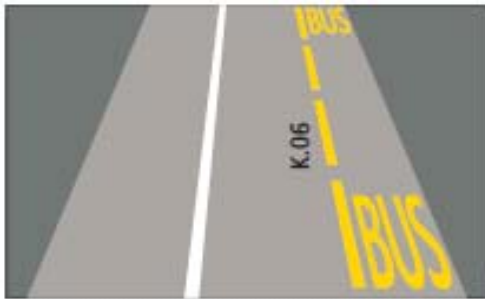
K.06 Voie réservée aux bus (art. 163, al. 1)
