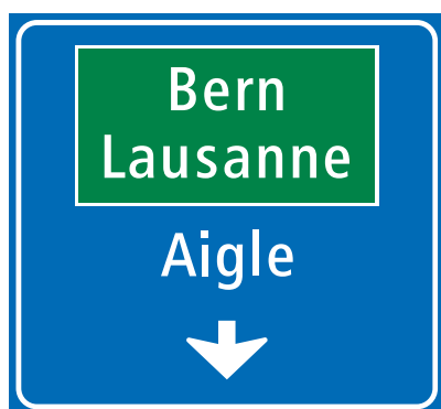
H.18 Panneau de présélection au-dessus d'une voie de circulation sur route principale (art. 136)
