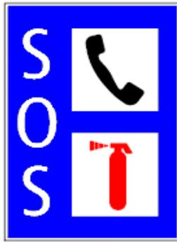
**G.24** Kombiniertes Signal Notfalltelefon und Feuerlöscher auf einer Signaltafel (Art. 133 Abs. 1)
