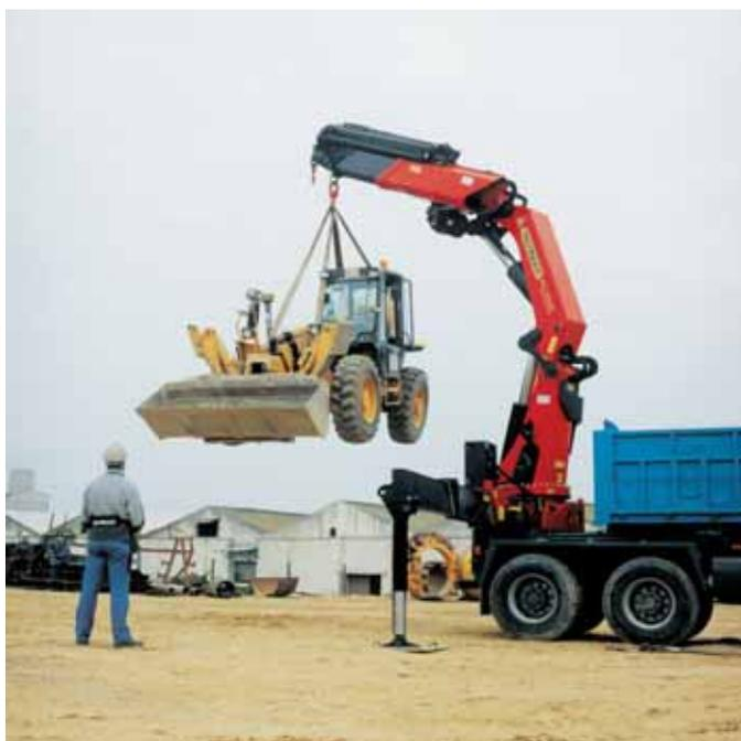
Photographie 6 (camion-grue): **grue de camion avec un moment de charge dépasse 400 000 Nm ou une longueur de flèche supérieure à 22 m**
