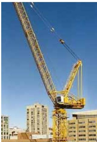
Photographie 9 (grue à tour pivotante): **grue à flèche relevable** (grue à tour pivotante avec fléchette).
