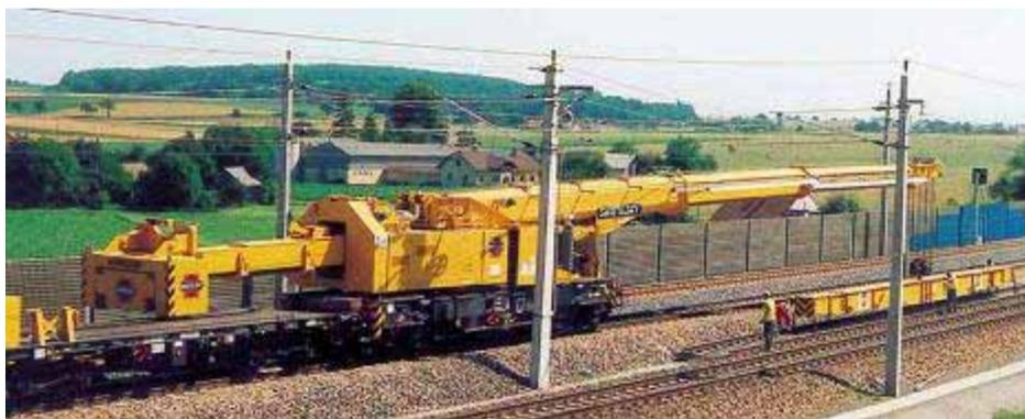
Photographie 4 (camion-grue): **grue ferroviaire équipée de treuil à câble.**
