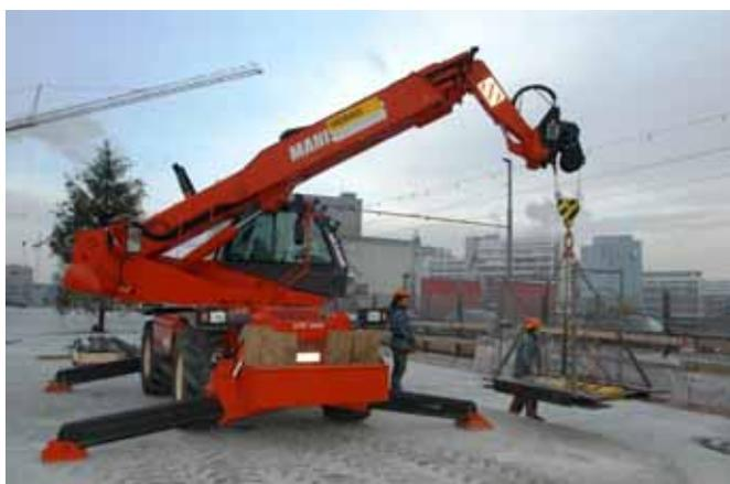
Photographie 5 (camion-grue): **chariot élévateur télescopique équipé de treuil à câble.**
