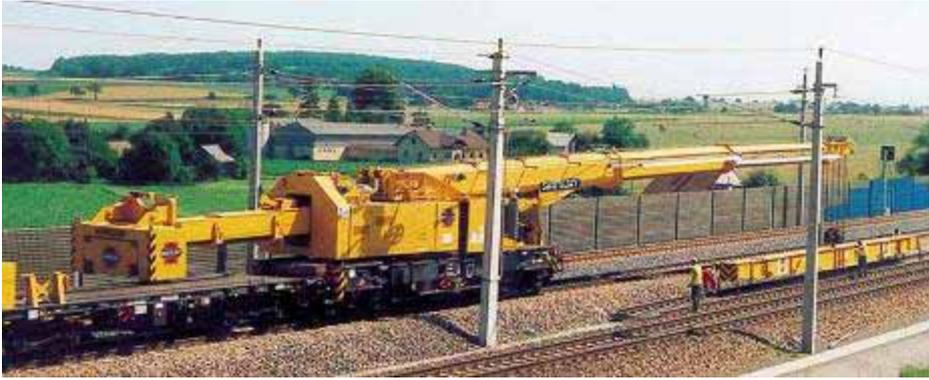
Bild 4 Fahrzeugkran: **Schienenkran mit Seilwinde**
