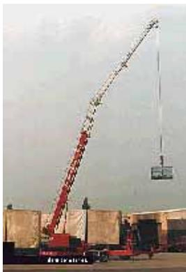
Bild 3 Fahrzeugkran: **Anhängerkran**
