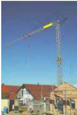
Bild 8 Turmdrehkran: **Untendreher** (Untendreherkran)
