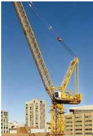
Bild 9 Turmdrehkran: **Wippkran** (Turmdrehkran mit Wippausleger, Turmdrehkran mit Nadelausleger)
