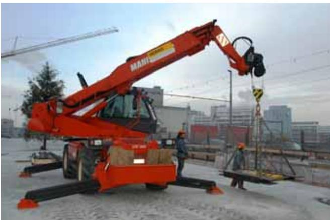
Bild 5 Fahrzeugkran: **Teleskopstapler mit Seilwinde**
