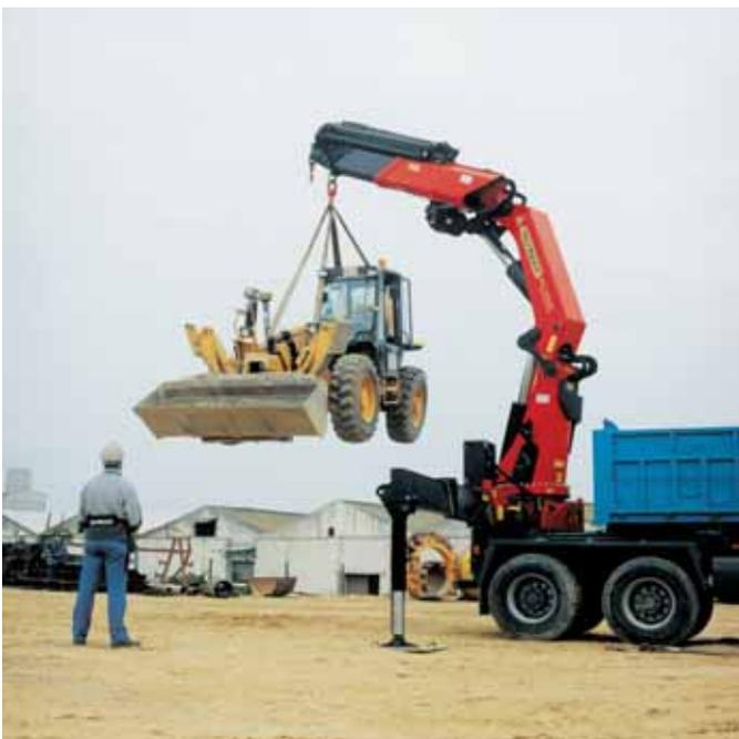
Bild 6 Fahrzeugkran: **Lastwagenladekran mit einem Lastmoment von mehr als 400'000 Nm oder einer Ausladung von mehr als 22 m.**
